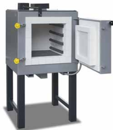
LF 60/15 mit Faserisolierung und Beheizung über SiC-Stäbe als Zusatzausstattung
