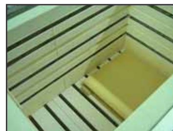
Brennraum mit 5-seitiger Beheizung
