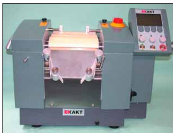
EXAKT 80 E mit Aluminiumoxidwalzen
